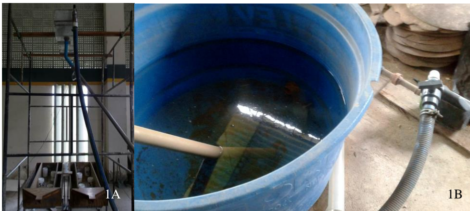
Figura 1A e 1B. Simulador de chuva e reservatório com a bomba centrífuga, respectivamente.
