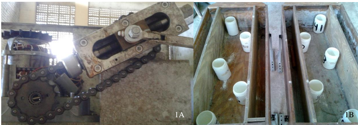
Figura 2A e 2B. Parafuso regulador da chuva precipitada e parcelas com pluviômetros, respectivamente.
